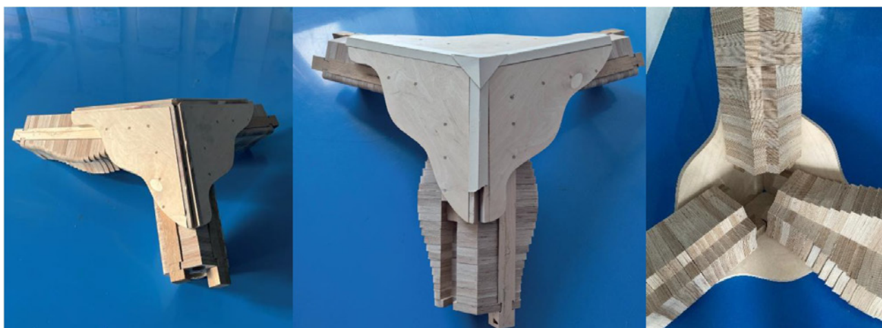
Mycobat, prototypage d'assemblage de trois caissons préfabriqués et assemblés par des connecteurs conçus et produits par Stratoconception®. Travaux de Victor Fréchar, Anwar Nehlawi, Julien Meyer, Gilles Duchanois, Arthur d'Arabian, Franck Besançon.
