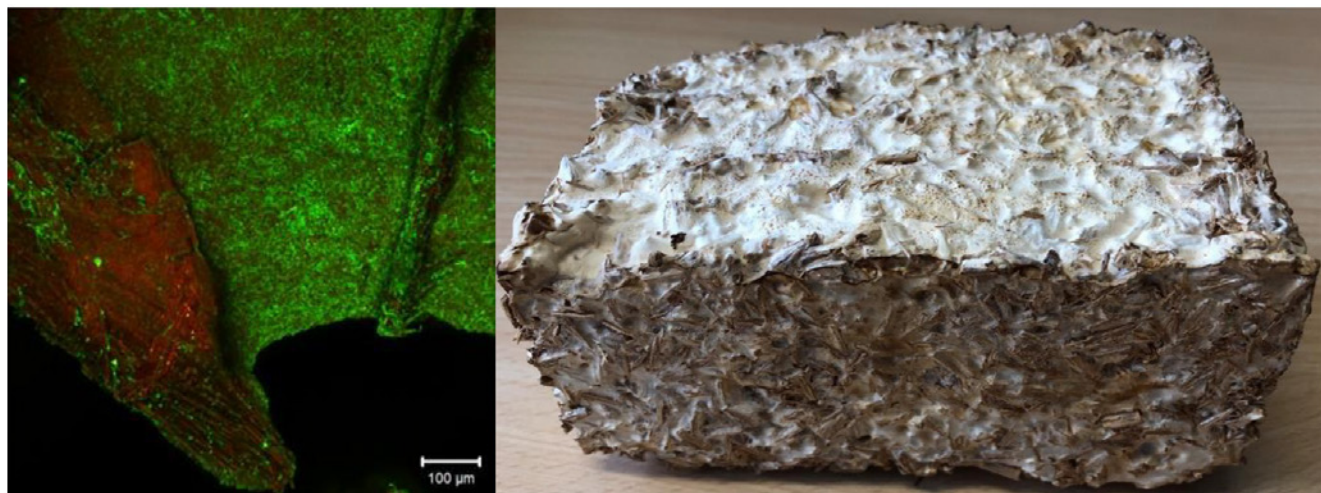
Mycocomposite développé par les équipes du LERMAB et du CRITT Bois. Travaux de Victor Fréchar d, Anwar Nehlawi , Julien Meyer , Gilles Duchanois , Arthur d'Arabian , Franck Besançon .
